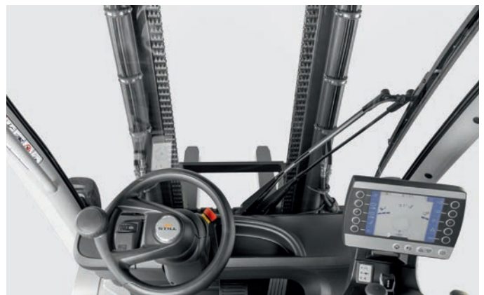
Montante telescopico per una visibilit  eccezionale in avanti
