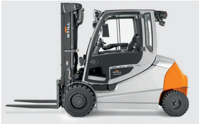
Cabina chiusa per uso esterno in qualsiasi condizione atmosferica
