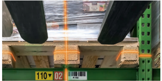
Laser a linee incrociate opzionale per determinare in sicurezza il centro del pallet
