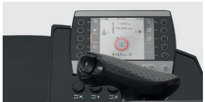
Display a colori STILL Easy Control con istruzioni per il conducente e tasti preferiti definibili dall'utente
