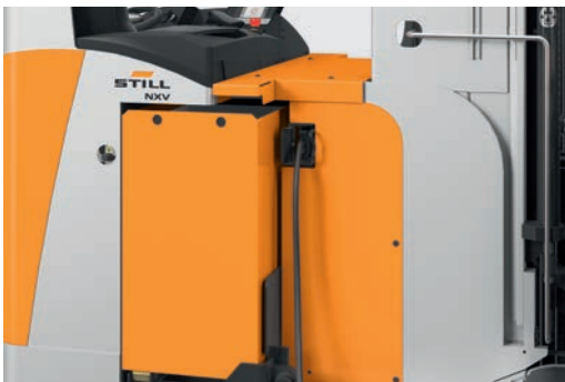
Accesso opzionale per la ricarica delle batterie agli ioni di litio
