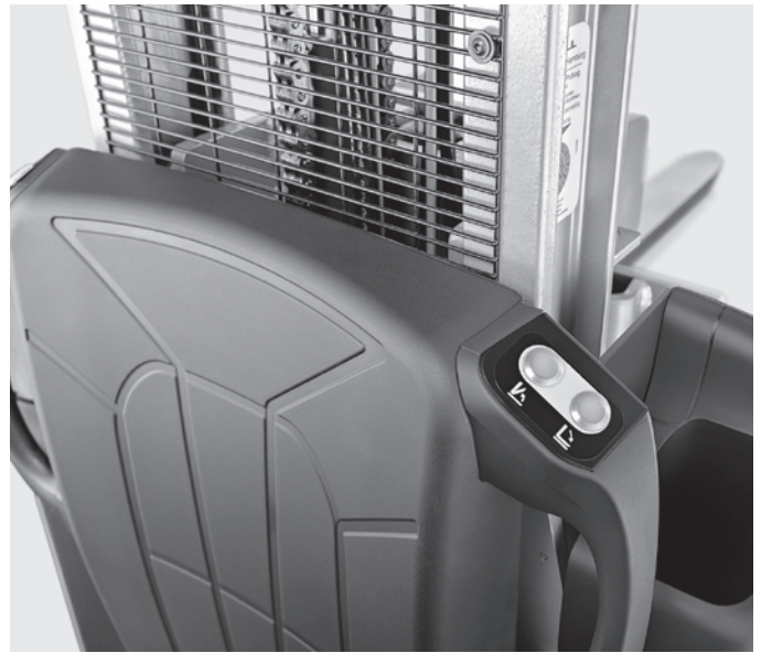
Meccanismo brevettato per il ripiegamento rapido e sicuro delle forche
