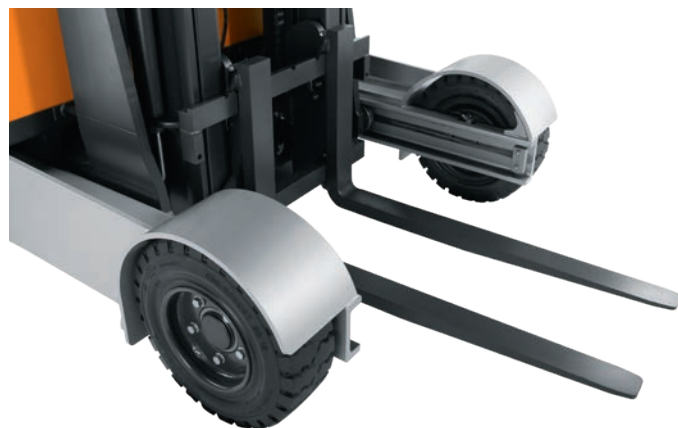
Ruote superelastiche con protezione ruote per una maggiore sicurezza
